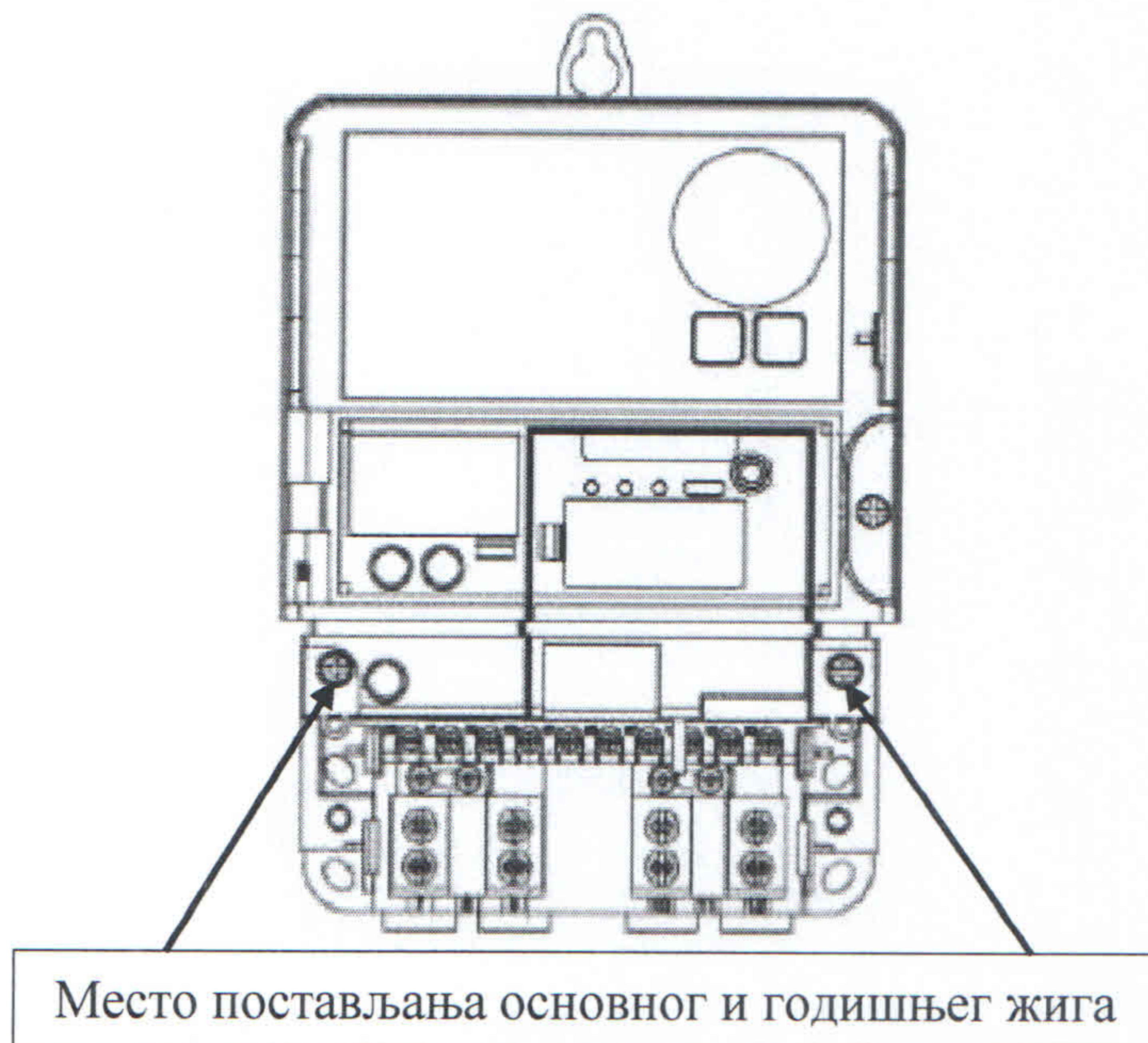
Слика 5. Место на бројилу за постављање оловне пломбе са основним и годишњим жиговима
