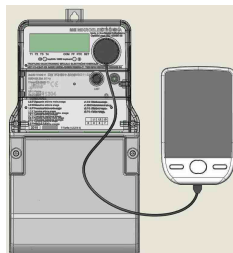
Slika 19. Komunikacija brojila i ručnog terminala upotrebom IC sonde
