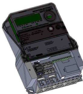
Slika 9. Način postavljanja komunikacionog modema na brojilo
